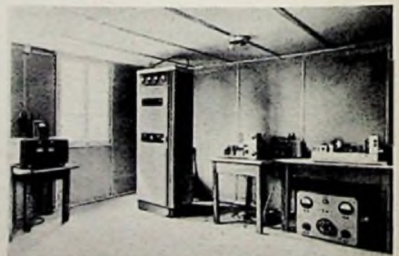
Der erste deutsche UKW-Rundfunksender. Er wurde am 28. Februar 1949 in München-Freimann aufgestellt und hatte 250 W Ausgangsleistung (Bild: Rohde & Schwarz)
