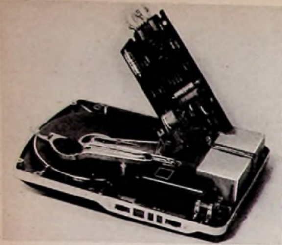
Bild 6. Traveller ohne Gehäuse mit herausgeklapptem Transistorverstärker
