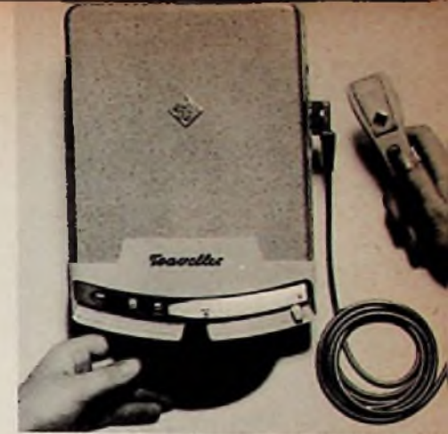
Bild 1. Batterielagespültes Diktiergerät Telefunken-Traveller mit Kurzzeit-Tonträger
