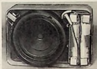
Bild 2. Die Abmessungen der Dose sind so gering, daß gerade der Miniatur-Kristalllautsprecher und zwei Stabzellen nebeneinander darin Platz finden
