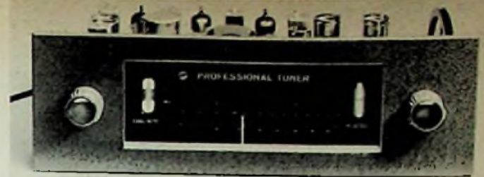
Bild 1. Ansicht des Professional-Tuners von Kurt Gabler, Zürich; jede Skala wird individuell von 88 bis 100 MHz geeicht
