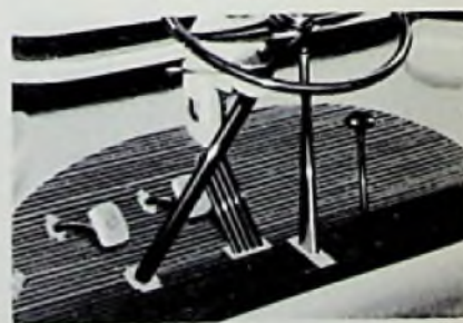
Gegen Zugluft und Kälte ist alles getan: Fußhebelwerk mit Filz- und Gummistulpen, Türen mit Moosgummi abgedichtet und Karosseriewände fugendicht verschweißt.
