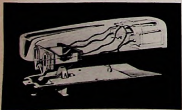
Bild 6. Skizze des Stereo-Kristallsystems AG 3064 mit Saphir-Nadel für Mikrorillen. Übersprechdämpfung zwischen beiden Kanälen > 22 dB
