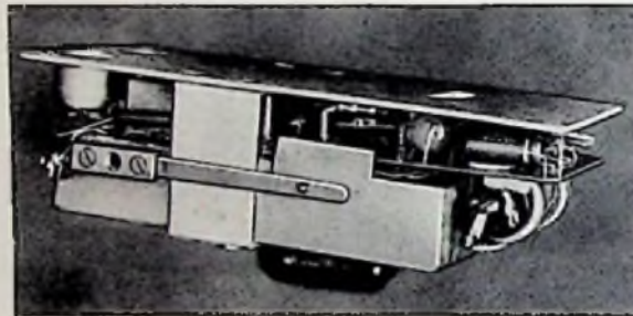
Bild 5. Seitenansicht des montierten Chassis mit der Zwischenplatte oben
