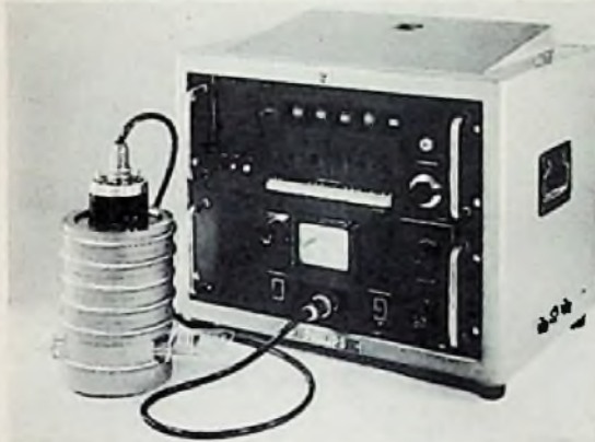
Bild 2. Strahlungsmeßplatz für Einzelzählungen, bestehend aus fünf Zähldekaden mit Röhren E 1 T, Vorverstärker und Stromversorgungsteil. Links eine Bleikammer zum Untersuchen radioaktiver Präparate und von oben eingesteckter Geiger-Müller-Sonde
