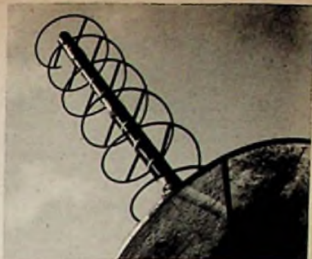
Bild 3. Breitbandige Helical-Antenne aus Alucell für den Empfang der Mondsignale
