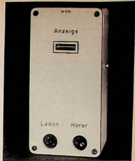
Bild 1. Geiger-Müller-Zähler M 576. Hinter dem kleinen Fenster im oberen Teil befindet sich die Abstimmröhre DM 70. Durch ihr Aufblitzen wird radioaktive Strahlung angezeigt; sie kann außerdem durch einen eingestöpselten Kopfhörer als Knacken hörbar gemacht werden. Der kleine Knopf an der rechten Seitenwand dient zum Einschalten des Gerätes
