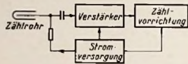
Bild 7. Prinzip eines Strahlungs-Meßgerätes
