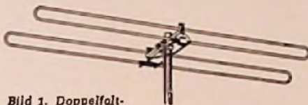
Bild 1. Doppelfaltantenne für einen Kanal in Band I mit geringer räumlicher Ausdehnung (Jaeger & Co., Bern, Lizenzbau R. E. Deutschlaender)
