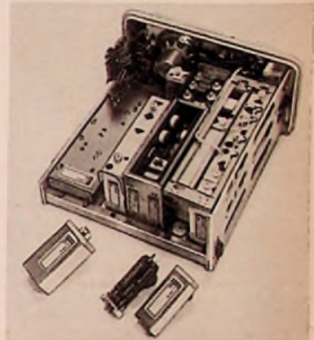
Bild 2. Montagerahmen des UKW-Funksprechgerätes, von links nach rechts sind angeordnet: Stromversorgungsgerät, Sender, Nf- und Kanalwähler-Einheit und Empfänger. Vor dem Gerät liegen links ein Senderbaustein (Vervielfachergruppe) und rechts eine Baugruppe aus dem Empfänger (erste Verstärkerstufe der 2. Zwischenfrequenz)
