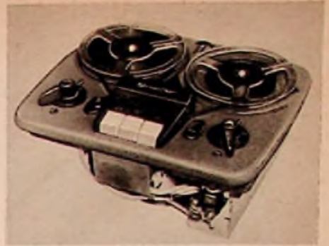
Bild 1. Das TK-5-Chassis fertig zum Einbau
