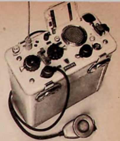
Bild 1. Tragbares Lotsen-Funksprechgerät Philips-„Portofon“ in wasserdichter und schwimmfähiger Ausführung
