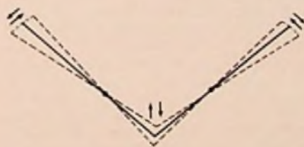
Bild 2. Darstellung des Schwingungsvorganges eines Papierkegels bei der ersten Teilschwingungsfrequenz F_1
