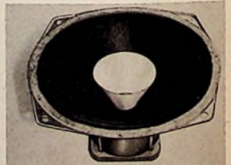
Bild 4. 4-W-Lautsprecher mit eingeklebter Hochtonegelmembran
