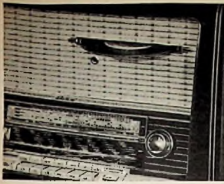
Bild 10. Schlitz zum Einführen der 17-cm-Kleinplatte (45 U/min) in den Loewe-Opta-Empfänger Luna-Box mit eingebautem Mignon-Plattenspieler
