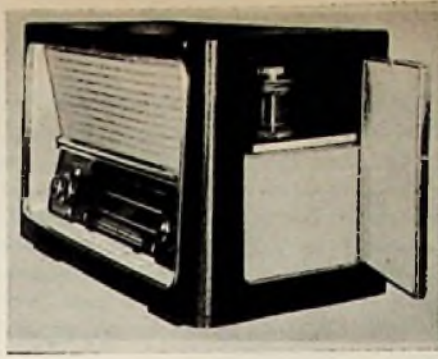
Bild 11. Dieser Zehnplattenwechsler für 17-cm-Kleinplatten (45 U/min) ist in die rechte Schmal-seite des Telefunken-Empfängers „Wunschkonzert“ eingebaut (links das vollständige Gerät, rechts Blick in den Wechsler-Raum)
