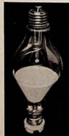
Bild 4. 4-W-Lautsprecher mit eingeklebter Hochtonegelmembran
