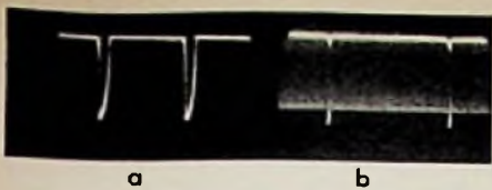
Bild 8. Oszillogramm der Synchronisierungssignale an der Anode der EH 90 in Bild 7. a) Zeile, b) Bild, jeweils 75 V cs
