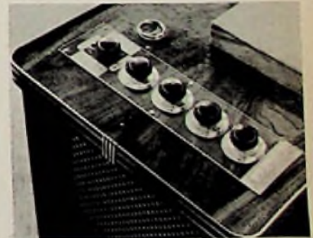
Bild 11. Die Bedienungsorgane der Anlage. Von links nach rechts vorn: UKW-Abstimmung, MW-Abstimmung, Tiefenregler, Höhenregler, Lautstärkereger, Drucktastensatz für MW, TA, Mikrofon und UKW
