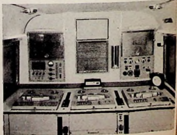
Unten: Bild 2. Der Magnetophon-Dreifach-Spieltisch mit Studiomoschlinen M 5. Rechts hinten ein Netz-Schaltfeld
