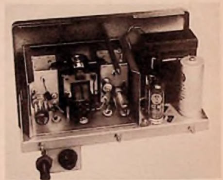
Bild 3. Innenaufbau; links der Oszillatorteil mit dem Motor zwischen den beiden Schwingkreisen, rechts der Netzteil
