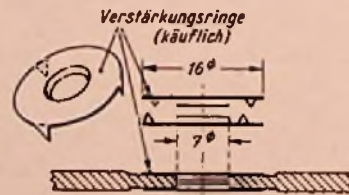
Bild 3. Ausführung einer Ringoerbstärkung. Die Ringe sind unter Erwärmen fest zusammendrücken, so daß sie nicht über die Schallplattenoberfläche hinausragen
