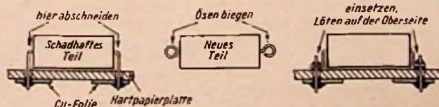
Bild 3. Austausch schadhafter Kleinteile bei einer gedruckten Schaltung
