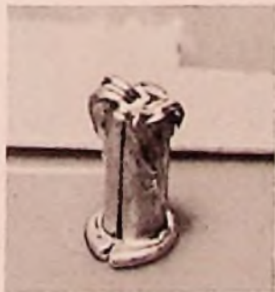
Rechts: Bild 3. Rohrnlöt mit durchgesteckten, umgebogenen und verlöteten Drahtenden
