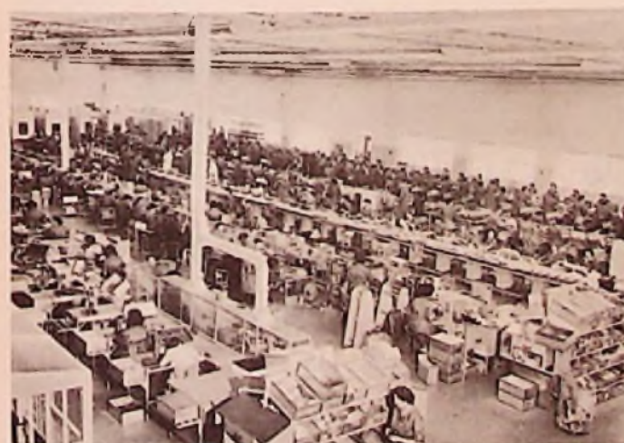
Teilansicht der Montagehalle mit fünf Bändern. Von links nach rechts: 1. Band Motorenfertigung, 2. Band Unterteilfertigung, 3. bis 5. Band Serienfertigung der Phonogeräte
