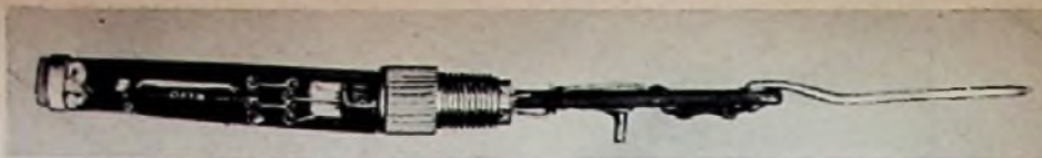
Bild 33. Innenaufbau des Tastkopfes
