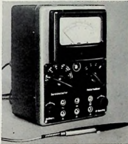
Bild 11. FUNKSCHAU-Röhrenvoltmeter M 561 mit Hf-Tastkopf. Für Nf-Messungen wird der Tastkopf oben in das Gehäuse eingesteckt
