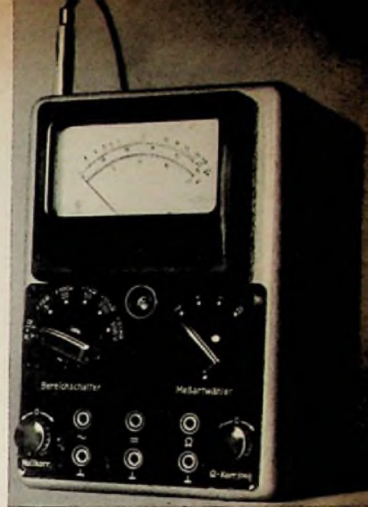
Das FUNKSCHAU-Röhrenvoltmeter M 561 für Gleich- und Wechselspannungsmessungen sowie zur Prüfung von Widerstandswerten
