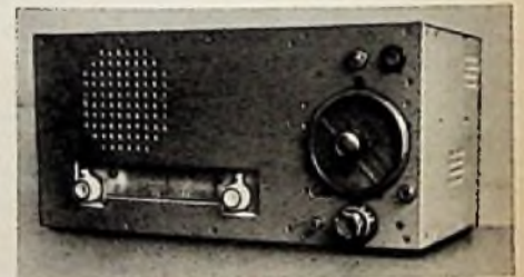
Kurzwellen-Konverter und Philips-Philetta als Spezial-KW-Empfänger im gemeinsamen Gehäuse
