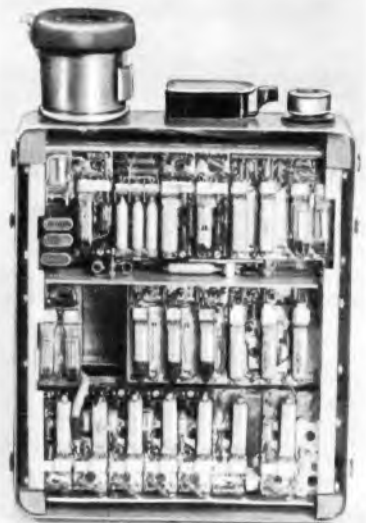
Das neue Telefunken-Kleinfunksprengerät „Teleport IV“ ist ganz in Subminiaturtechnik ausgeführt. Nicht nur die Röhren, sondern auch alle Bauteile haben entsprechende Größen
