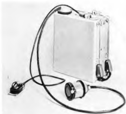
Telefunken-Teleport IV mit Mikrofon/Lautsprecher; links Kanalwahlschalter für getrennte Montage
