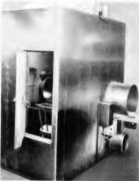
Abstrahlkühlig MGL 4100 von Grundig. Die Öffnungen zum Einsteigen, zum Durchschieben der Geräte und zur Belüftung sind vollkommen störstöricher
