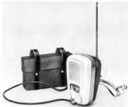
Fahrradempfänger von AWB mit Teleskopantenne und Batterietasche
