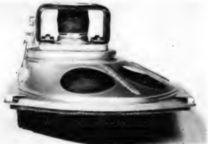
Bild 1. Exzentrischer Hoch- und Mittelton-Seitenlautsprecher für 3-D-Geräte (Isophon)
