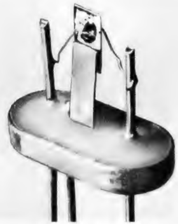
Bild 1. So einfach sieht ein neuzeitlicher Flächen-Transistor in starker Vergrößerung aus, und doch ist hierüber eine ganze neue Wissenschaft entstanden (SAF-Transistor ohne Kappe)
