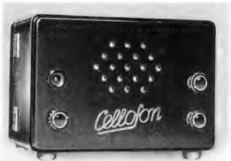
Bild 1. Das erste Modell des Cellofon, eingebaut in ein Isoliergehäuse mit den Abmessungen 120 x 180 x 60 mm
