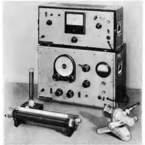
Dämpfungsmeßplatz für 300... 1000 Hz mit dem Siemens-Meßsender 3 W 58
