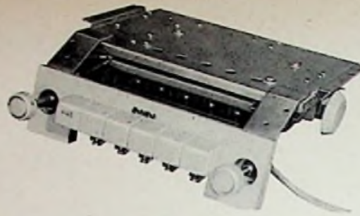
Bild 5. Teilnehmer-Empfänger der Hotelfunk-Anlage
