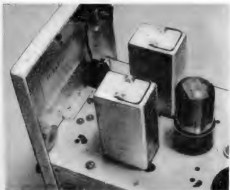
Bild 5. Teilansicht der elektronischen Taste nach Bild 4 mit den beiden Relais
