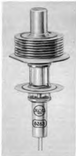
Dezimeterwellen-Triode in Koaxialtechnik
