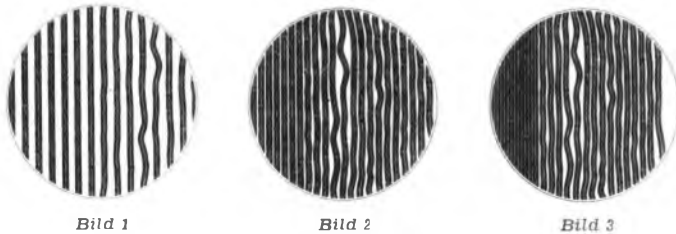
Bild 1. Mikroaufnahme einer normal geschnittenen Schallplatte mit festem Rillenabstand. Bild 2. Platte mit älterer Füllschrift (links sieben Rillen ohne Musik). Bild 3. Füllschrift neuester Entwicklung mit geringstem Steg zwischen den Rillen, sobald diese keine oder nur ganz leise Musik enthalten (links im Bild)
