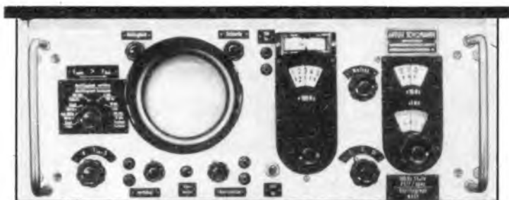
Feindekade NDF 1 zur Erweiterung des Dekadenbereichs auf 100 Hz-Synchronisierpunkte
