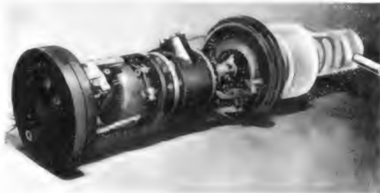
Bild 1. Antriebsmotor mit Umsteuer-Einrichtung
