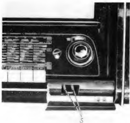
Bild 6. UKW-Stationstasten mit den zugehörigen Einstellschrauben S hinter einer heruntergeklappten Schutzleiste (Blaupunkt)
