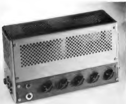
Bild 1. Breitband-Mischverstärker V 111 mit den geringen Abmessungen 270 x 105 x 160 mm (Klein & Hummel). Die Grundfläche ist kleiner als ein halbes DIN A 4-Blatt. Auf der Vorderseite befinden sich, übersichtlich angeordnet, die Regler für Tonabnehmer-, Rundfunk- und Mikrofon-Eingang sowie die Knöpfe für die Höhen- und Tiefenregelung
