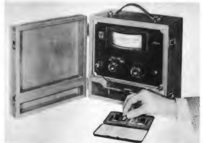
Bild 1. Gerät zum Prüfen der Oberflächen-Rauigkeit von Werkstücken (Philips PR 9150). Kontrolle des Tasters und der Skala mit Hilfe von Rauigkeitsnormalen
