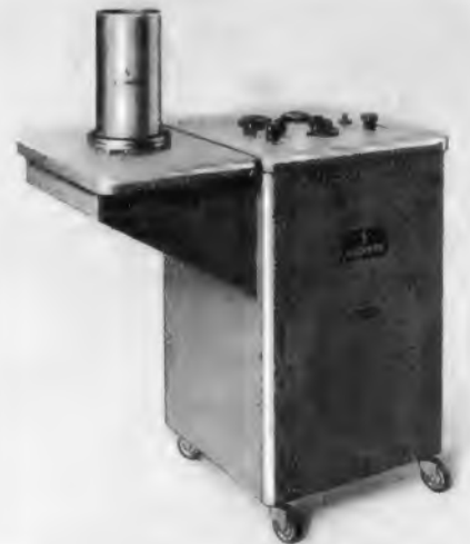
Links: Bild 2. Hochfrequenzformenpresse mit 2-kW-Generator der Siemens-Schuckertwerke. Unten am Fuß der Presse ein fertig geformtes Sperrholzteil
