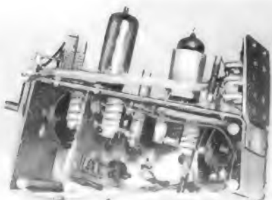
Bild 11. Der geöffnete UKW-Baustein von Loewe-Opta mit Dreifach-L-Abstimmung
