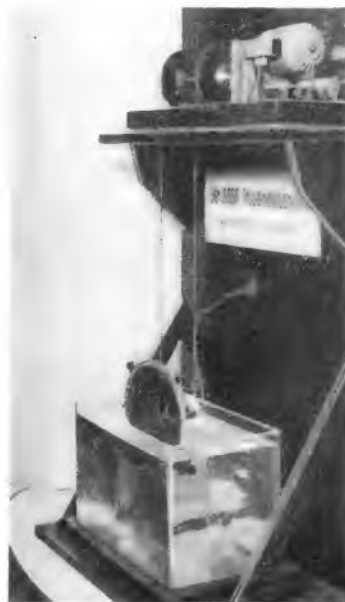
Saba-Tropenlautsprecher bei der Tauchprobe
