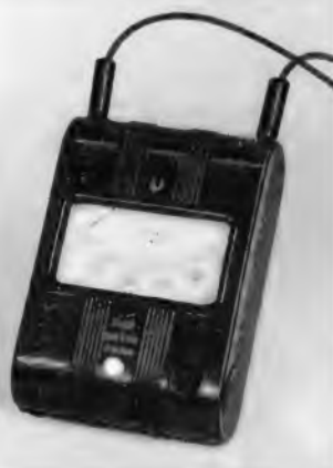
Spezialmeßgerät von Gossen zur Messung der Fußbodenleitfähigkeit. Beim Drücken des weißen Knopfes wird der 3-kΩ-Parallelwiderstand angeschaltet
