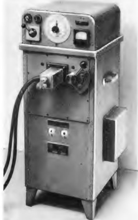
Bild 5. 500-W-Hochfrequenzgenerator für induktive Erwärmung. Die Arbeitsfrequenz beträgt 2,6 MHz. (Himmelwerke AG, Tübingen)
