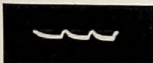
Bild 190. Oszillogramm des An- und Abklingvorgangs nach Bild 186 bei Einschaltung des Gliedes RC nach Bild 187
