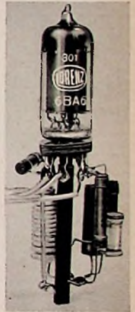
Praktische Einzelteilanordnung bei modernen Röhrenfassungen. Mit Hilfe eines Isolerröhrcchens werdende Schaltelemente in Längsrichtung zur Röhrenachse angeordnet
