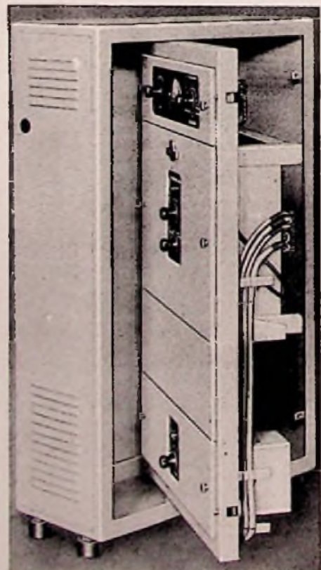
Rechts: Bild 3. Vollständig ausgeschwenktes Verstärkergerätestell. Die Verbindungskabel zur Rückwand bleiben angeschlossen. Eine Netzsteckdose gestattet bequem LötKolbenanschluß bei Reparaturen
