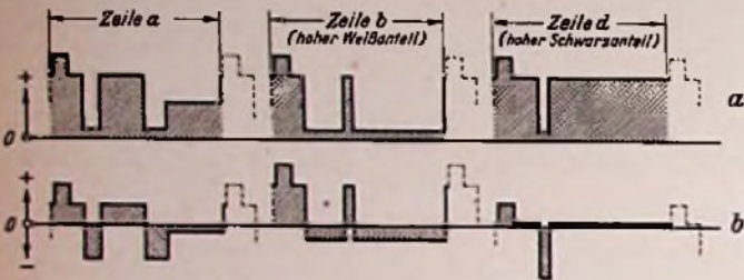
Bild 76. Verlauf von Bild-Nf-Spannungen. a = Gleichspannungsanteil beibehalten, b = Gleichspannungsanteil durch einen Kopplungskondensator verlorengegangen
