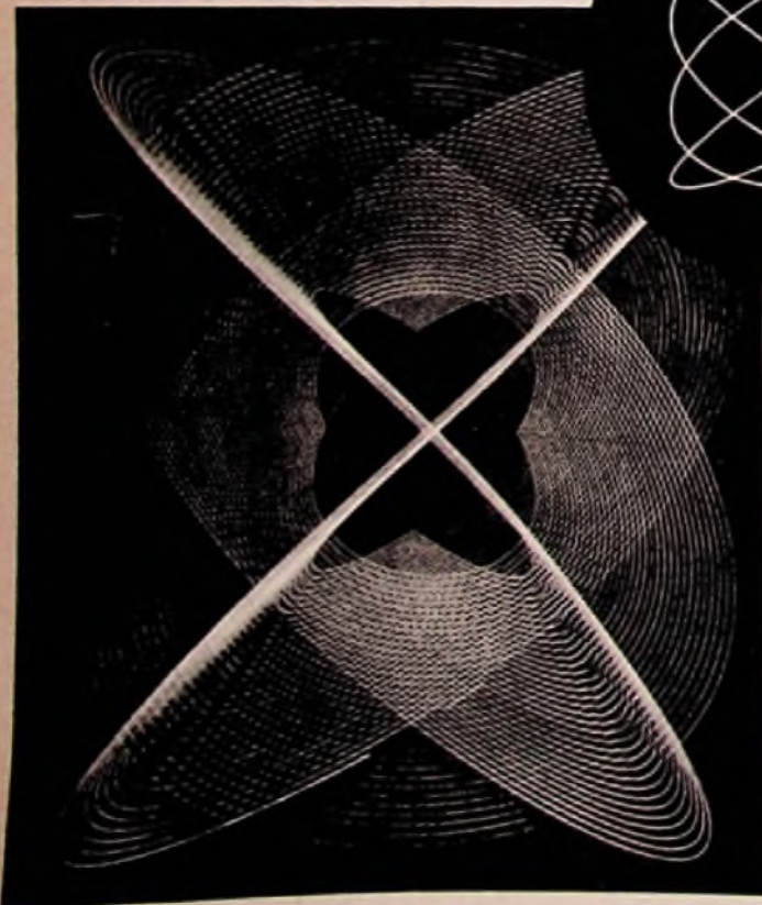
Bild 2. Elektronisch aufgezeichnete Lissajou-Figur mit dem Frequenzverhältnis 3:4
