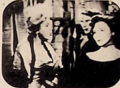
Bild 74. Zu starker Bildkontrast durch Übersteuerung der Bildröhre. (Aus der Fernseh-Bildfehler-Fibel von O. P. Herrnknd; Radio-Praktiker-Bücherel, Band 51)
