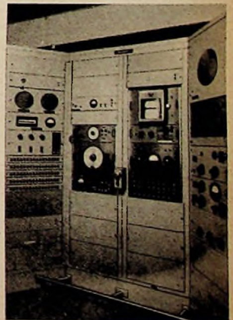
Bild 4. Ansicht eines zentralen Meßplatzes mit Drucktasten-Steuerung
