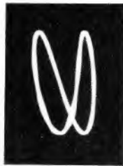
Bild 115. Phasenlage zwischen synchronisierender und synchronisierter Spannung
