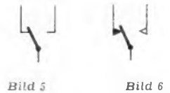
Bild 5. Darstellung von Relaiskontakten nach DIN 40700
