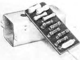
Bild 7. Praktisches Aufbaubeispiel für einen Radiodetektor nach Bild 6
