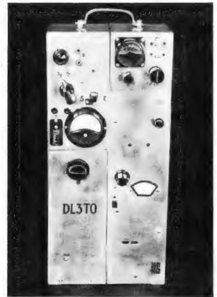
Vorderansicht der beiden zusammengeführten Baukörper. Rechts die Sendereinheit, links die Empfängereinheit. Die Abmessungen betragen ohne Bedienungsknöpfe u. Griff: Höhe 400 mm; Breite 185 mm; Tiefe 80 mm. Durch den länglichen, rechts unten sichtbaren Schlitz wird der endgültige Abgleich des 2. UKW-Kreises vorgenommen
