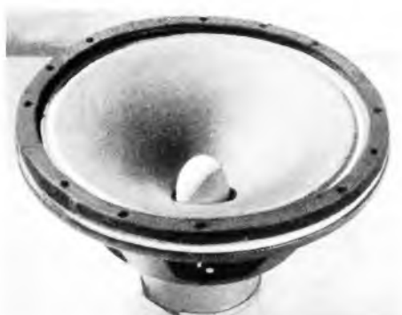
Durch das „Ei des Pfenninger“ wird der alte Lautsprecher zum Breitbandgerät; eine halbe Eischale (spitze Hälfte) verbessert die Wiedergabe der hohen Töne
