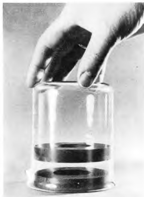
Bild 1. Der obere Ferroxdure-Magnet wird durch die abstoßende magnetische Kraft beider Ringmagnete in der Schwebelage gehalten. Der Glasbecher dient zur Zentrierung.
