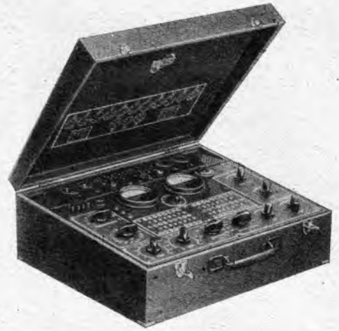
Bild 1. Ein Blick auf die Frontplatte des Röhrenmeßgerätes „Tubatest-M 1“ läßt die übersichtliche und zweckmäßige Anordnung der Bedienungorgane erkennen. In der Mitte befinden sich sechs Steckerleisten für die Spannungszuführung an die Röhrelektroden, darüber sind Strom- und Spannungsmesser angeordnet. Ganz oben sieht man die Röhrenfassungstafel mit den beiden Glimmlampen L1 und L2. Unten haben links die Gitterspannungsregler mit der Vakuum-Prüfstaste und rechts die Anoden- und Schirmgitterspannungsregler Platz gefunden. In der Mitte sieht man den Prüfschalter und den Spannungsschalter. In der Mitte des Meßgerätes wurden auf der linken Seite Heizumschalter und Heizspannungsschalter angeordnet. Auf der rechten Seite befinden sich Netzregler und das U g4 — Potentiometer
