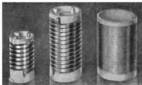
Bild 1. Bei keramischen Spulen mit aufgebranntem Leiter läßt sich gegenüber gewickelten Spulen eine Metallersparnis von über 50% erzielen.
