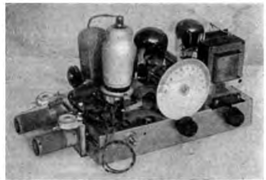
Bild 2. Auf dem VE-Gestell entstand aus leicht beschaffbaren Teilen und Selbstbau-Spulen dieser kriegs-mäßige Einbereich-Superhet.
