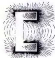
Bild 2. Ziemlich offener Eifenkern und zugehöriges Feilpanbild.
