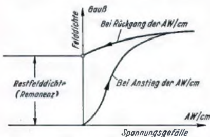
Bild 11. Die Magnetisierungskurve läßt die Restfeldstärke erkennen.
