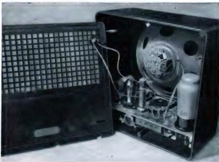
So einfach ist der Einbau des Schnellstarters in den DKE — er besteht aus einem Isolierstoff-Druckknopf, der einen Teil des Heizwiderstandes kurzschließt. (Bild: Herbert Hoffmann)
