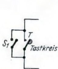
Bild 1. Der Dauerstrichschalter liegt parallel zur Morfetaste.
