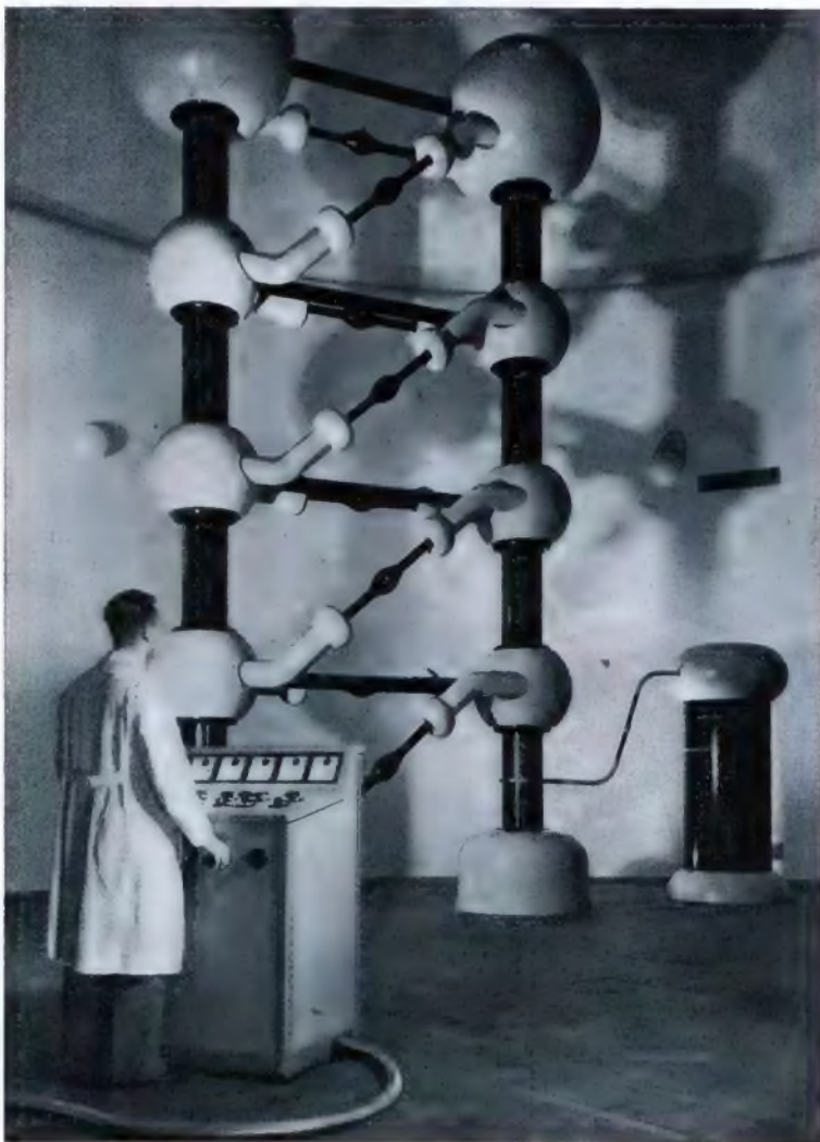
Für die Forschungsarbeiten am Atom-Aufbau sind sehr hohe Gleichspannungen erforderlich. Die Elektrotechnik hat hierfür Hochspannungsanlagen geschaffen, mit denen mehrere Millionen Volt konstanter Gleichspannung erzeugt werden können. Unter Bild zeigt einen von zwei 1,5-Millionen-Volt-Generatoren, die zu einer von Siemens & Halske gebauten 3-Millionen-Volt-Anlage gehören. Die Anlage befindet sich in dem unter Leitung von Professor Dr. Debye stehenden, in Berlin-Dahlem neu errichteten Kaiser-Wilhelm-Institut für Physik. Sie dient der Forschung auf dem Gebiete der Kernphysik.
