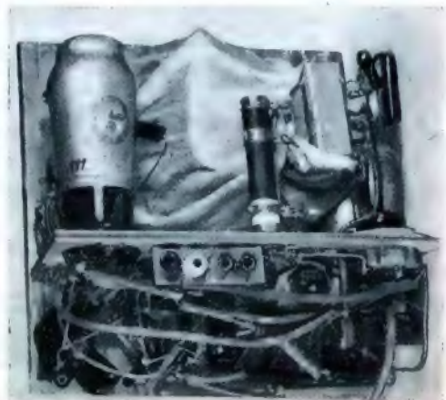
Innenansicht des Kleinempfängers.
