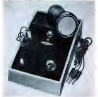
Das Mikrofon-Regiepult. (Werkbild)
