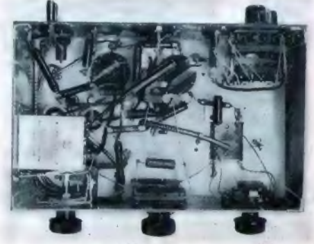
Die Unterseite des fertigen Empfängers.
