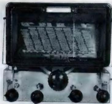
Oben: Vorderansicht des Einkreifers mit V-Röhren. Die schöne Großlichtkala ist mit zwei Winkeln an der Vorderseite des Gestells angebracht.
