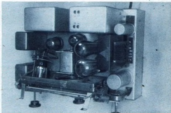
Ein Blick auf die übersichtliche Einzelteilanordnung läßt erkennen, daß unter Verwendung eines raumsparenden Zweifach-Drehkondensators die Skala in ihrer gesamten Einbautiefe auf dem Aufbaugestell Platz finden konnte.
