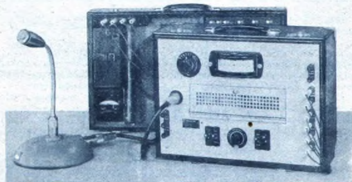
Der Schalldruckmesser mit Mikrophon und Batteriekoffer. (Werkbild: Siemens)
