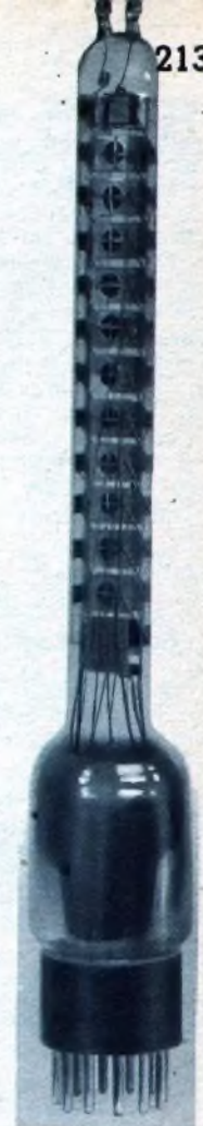
Links: Abb. 16. Eine der ersten deutschen Vervielfacher-Typen, die bereits 1935 ihre praktische Verwendung beim Fernsehsprechen der Deutschen Reichspost fanden. (Aufn.: RPZ-Bildstelle - 2)
