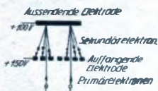
Abb. 1. Gewünschte Sekundäremission. Die auffangende Elektrode hat eine höhere Spannung als die Sekundärelektronen ausstrahlende Elektrode.
