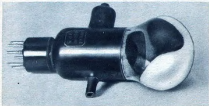
Abb. 19. Loewe-Sekundär-Photozelle mit fünfstufigem Gitter-Vervielfacher. Das erste — im Bild gut sichtbare — Prallgitter ragt in den Kathodenraum hinein, um die Wirkung der Saugspannung zu erhöhen. Links ist der (verlustarm ausgeführte) Anluß der Arbeitsanode (Kollektor) zu sehen. (Werkphoto)
