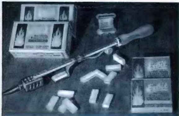
Der LötKolben mit einigem Brennstoffvorrat. In die Heizkammer wird durch einen Schieber eine Tablette eingeführt.
