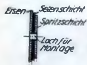
Links: Abb. 1. Schnitt durch ein Selen-Gleichrichter-Element.
