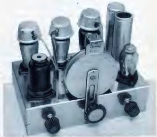
Ein einfaches Stromsparendes Gerät für den Kurzwellenempfang, wie es sich viele wünschen werden. Links die KW-Spule.
