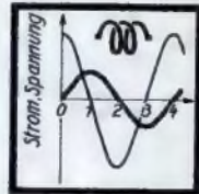
Links: Abb. 3. Beim Kondensator sind Spannung und Strom nicht miteinander „in Phase“. Der Strom eilt voraus.
