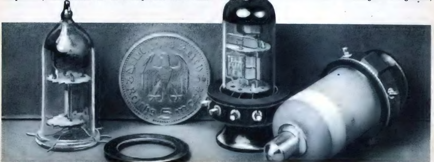
Spezial-Dreipolröhre SD 1 A (Bild mitte) und Spezial-Fünfpolröhre SF 1 A (rechts) mit dem sechspoligen Stützsockel und dem abführbaren Sockelknopf. Links eine ungefokelte Dreipolröhre, deren System unmittelbar von der unteren Glimmerhalterung bzw. von dem unteren Kolbenabfluß (Glasteller) getragen wird. Der Ring rechts wird über die Röhre gezogen, auf den Wulst des etwas vorstehenden Kolbenbodens aufgelegt und dann von unten her der Sockelring mit dem noch oben offenen Stützröhrchen angelegt und angeklippt. Zuletzt werden in die Stützröhrchen die Elektrodenleitungen eingelegt und eingelötet. (Aufn. Herrnkind)
