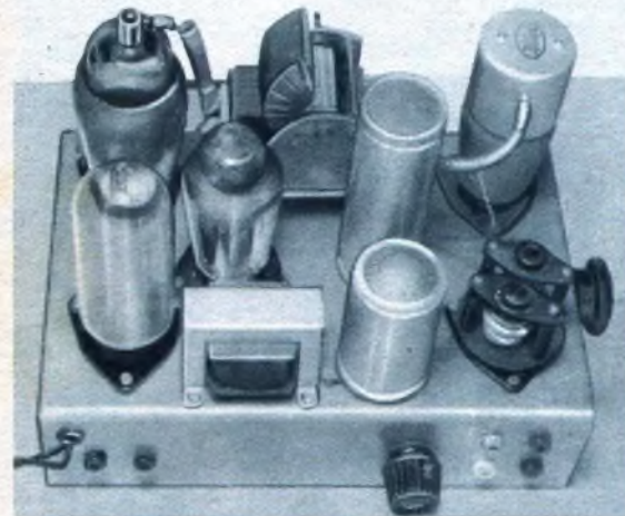
Die Verteilung der Einzelteile auf dem Chassis. Rechts vorne die Spule, die gegen eine Kurzwellenspule austauschbar ist.
