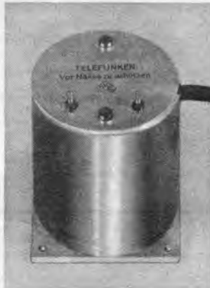
Der Überträger, der für Sonderfälle nützlich sein kann, ist in einem Topf untergebracht.
