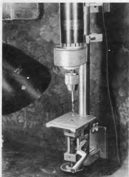
Abb. 3. Diefelbe Maschine als Wandbohrmaschine und Schleifmaschine.
