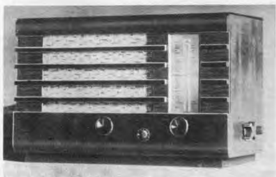
Der Einkreifer der Fa. Loewe (Opta 137 W), gleichfalls mit Stromsparhaltung. Werkphoto.
