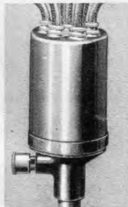
Rechts: Abschirmhauben für Verteiler, Lichtmaschinen, Schelbenwischer usw. bewirken eine Unterdrückung von Störungen. Die Mentor-Abschirmhauben beruhen auf der Erfindung, auf eine gut biegbare Unterlage eine Metallschicht aufzutragen. Werkaufnahme Mentor.
