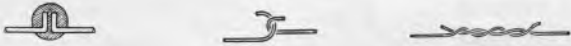
Abb. 2. Wenn man nicht die Drähte, wie rechts gezeigt, gegenseitig verwinden kann, so muß man, damit das Ganze auch hält, entweder Ofen machen oder das Drahtende rechtwinklig abbiegen.
