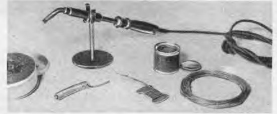
Abb. 1. Ein elektrischer Bastler-Lötkolben im Ständer. Davor Lötfett, einige Rollen Lötdraht und flüssiges Lötzinn.
