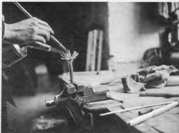
Abb. 3. Beispiel einer Aluminiumlötlung. Das Aluminiumkabel wird stark erhitzt, und während des Verzinnens wird jede einzelne Seele mit einer Drahtbürste abgebürstet, um die Oxydschicht zwischen Aluminium und Alulot zu zerstören.
