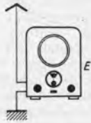
Abb. 2b. An den Kontrollempfänger stecken wir Antenne und Erde, damit die Spule des Dynatrons einwirken kann.
