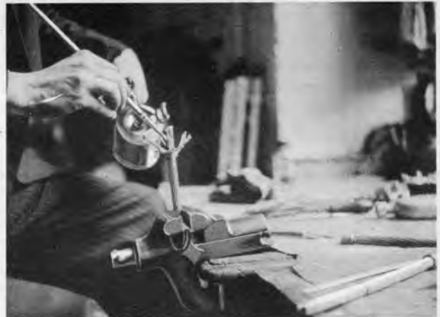
Abb. 4. Die einzelnen Seelen sind teilweise wieder zusammengebogen und werden nun von der anderen Seite verzinkt und gebürstet. Nur so wird eine tatsächlich haltbare Aluminiumlötlung erreicht. (Sämtliche Aufnahmen vom Verfasser.)
