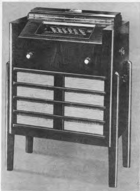
Oben: Eine Musiktruhe der Firma Saba ohne Schallplattenteil. Charakteristisch die Klapp-Skala, die allen diesjährigen Saba-Geräten gemeinam ist. Werkphoto.
