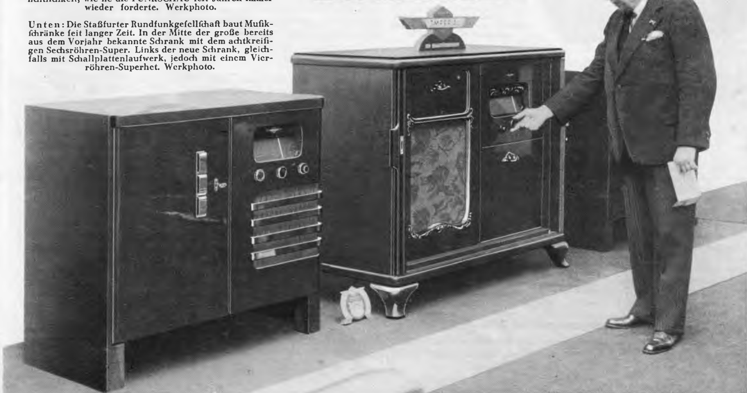
Rechts: Der Telefunken-Wagen besteht aus Schallplattenlaufwerk, Empfänger und nicht eingebauten Lautsprecher. Die Skala besitzt eine Größe und Übersichtlichkeit, wie sie die FUNKSCHAU seit Jahren immer wieder forderte. Werkphoto.
