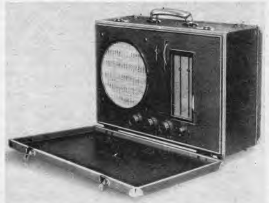
Eine ruhige, vornehme Front zeigt sich nach dem Aufklappen des Deckels. Der Zweikreis-Vierröhren-Koffer „Seibt 246 K“. (Werkbild)
