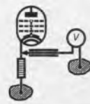
Abb. 2. In Schaltungen, wo die Vorspannung durch Kathoden-Widerstände erzeugt wird, mißt man gemäß dieser Schaltung.
