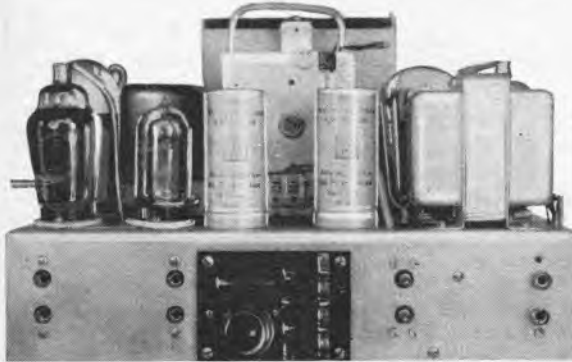
Auf dem rückwärtigen Chassisteil ist eine Pertinaxplatte befestigt, die den Stromartumschalter und die Spannungsumschaltungseinrichtung trägt. Zur Spannungsumschaltung dient eine Sicherung, die einfach in den entsprechenden Halter geklemmt wird.
