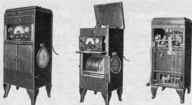
Eine vorbildliche Bastelarbeit. Ein Musikschrank mit Plattenspieler, darunter ein Vierröhrensuper, nach unten folgen weiter: Plattenständer, Freischwinger-Lautsprecher und Netzanschluß. In der Mitte noch ein Fach für die Radiozeitung. Der Super hat an der Rückseite Messerkontakte, so daß man ihn nach vorne herausziehen und nach Herzenslust herumbasteln kann. Aufnahmen Paul Taufhke.
