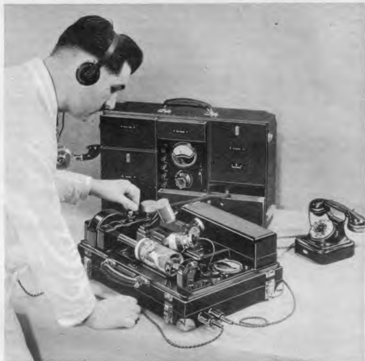
Der tragbare Bildfender besteht aus zwei Koffern, die alles Notwendige enthalten, so daß nur noch ein Fernsprech-Anschluß erforderlich ist, um die Bilder weitergeben zu können. Werkphoto Siemens & Halske A.-G.
