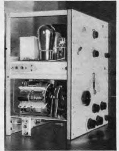
Unter Spulenrevolver in einem vorbildlich. Kurzwellenempfänger eingebaut. Photo E. Barth.
