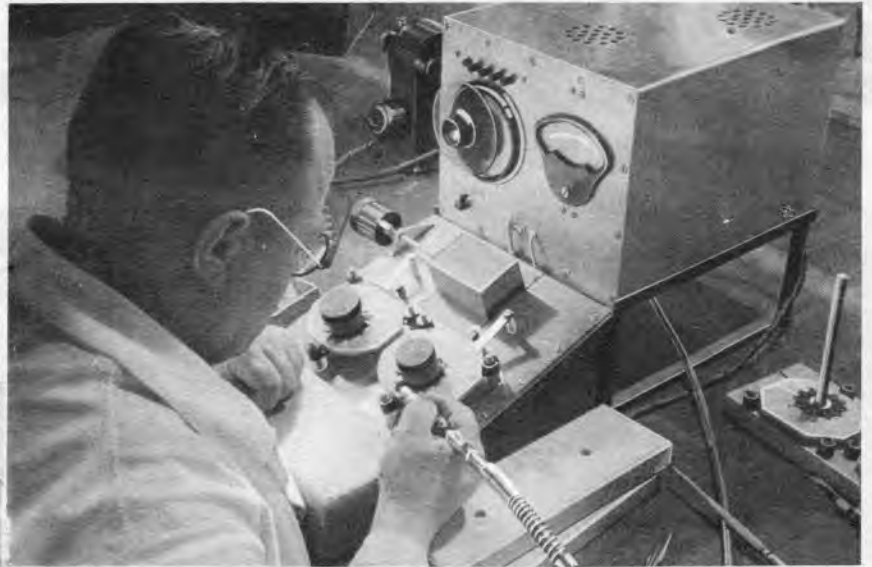
Das Schleifen der Wählerplatten für den Wählerautomaten. Auch hier wird die Einzelkapazität mit Hilfe einer Meßbrücke mit einem Normal verglichen.
