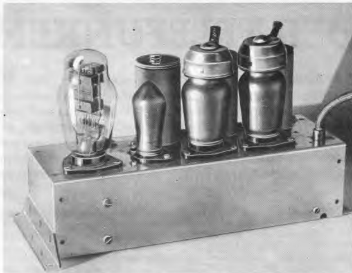
Ein Block für sich: Der Tonempfangsteil des Fernsehers FE IV. Werkphoto.
