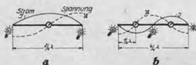
Abb. 3. Wie sich Strom und Spannung auf einem einfachen Hertz-Dipol verteilen: An beiden Seiten ein Spannungsbauch. Bei Erregung in der Grundschwingung der Strombauch in der Mitte (a), bei Erregung in der 2. Harmonischen (b) ist ein weiterer Spannungsbauch in der Mitte.
