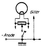
Taftendruckes bekommt die Röhre also eine höhere Spannung. Bei selbstregerten Sendern führt dies zum „heulenden“ Zeichen-einsatz, da sich die Sendefrequenz um ein geringes (einige 1000 Hz) ändert. Man muß deshalb durch einen Lastausgleich dafür sorgen, daß auch in den Taftpauzen die Anodenspannung niemals über den Betriebswert ansteigen kann. Fig. 20
