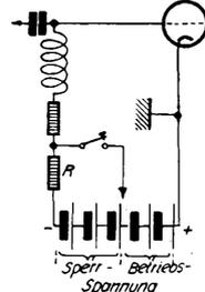
Taften hervorruft. Einwandfrei kann nur durch „Sperrung“ durch eine Batterie getaftet werden (Fig. 21), wobei deren Spannung so groß sein muß, daß im ungetafteten Zustand der Anodenstrom Null wird. Im getafteten Zustand wird die Batterie (oder ein Teil) über einen Schutzwiderstand R ( $10\,000 \div 50\,000 \Omega$ ) kurzgeschlossen. Die Größe der Sperrbatterie richtet sich nach der Röhre, meistens genügen etwa  $100 \div 200$  Volt.
