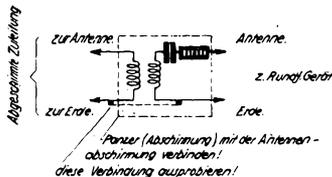
Wenn man mehrere Empfänger an einer Antenne betreiben will, so muß vor jeden Empfänger eine Kopplungseinheit geschaltet werden, wie hier zu sehen.
