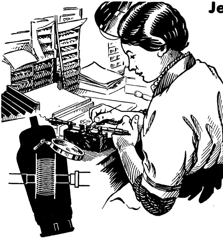
**Jedes VALVO-Oktodengitter wird auf Maßhaltigkeit geprüft**
