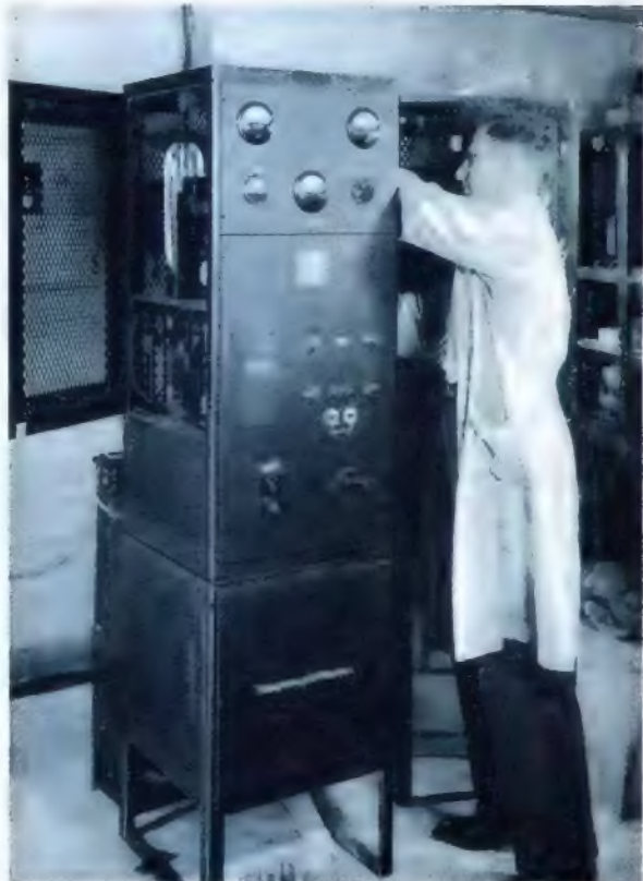
Der größte Verstärker mit 800 Watt, gebaut von der Firma Telefunken für die Groß-Lautsprecheranlage auf dem Tempelhofer Feld in Berlin. (Werkphoto)
