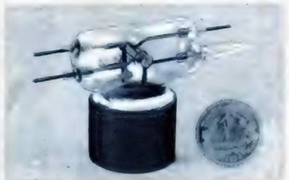
Und noch einmal eine Habann-Röhre. Die vier Anschlußdrähte führen zu den vier Teilen der Anode.
