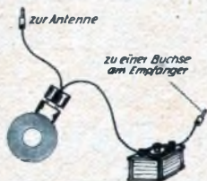
Eine altherwährte Methode, den Langwellenempfang zu verbessern: Eine Spule und einen Drehkondensator in die Antenne legen!
