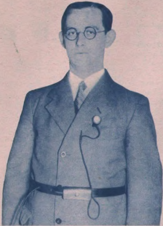
So trägt man das Knopflochmikrofon. Die Zugentlastung der Anschlußleitungen ist deutlich zu erkennen.
