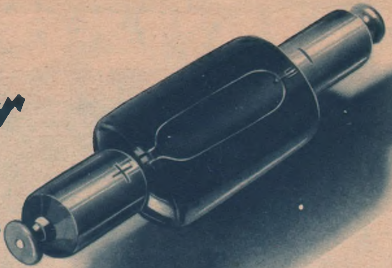
Das ist eine Photozelle, wie sie häufig benutzt wird (natürliche Größe).
