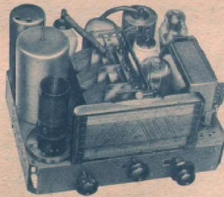
Das Chassis. Eine der Spulenabstirnhauben ist abgenommen.
