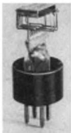
Diese Röhren besitzen große Steilheit, aber auch verhältnismäßig hohen Anodenstrom.
