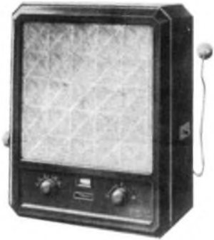
Abb. 1. In diesem ruhigen äußeren Gewände erscheint der Nora-Dreiröhren-Wechselstromempfänger.
