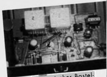
Ein typischer Bastelempfänger mit Umschaltspulen der Industrie, alles auf Holz gebaut
